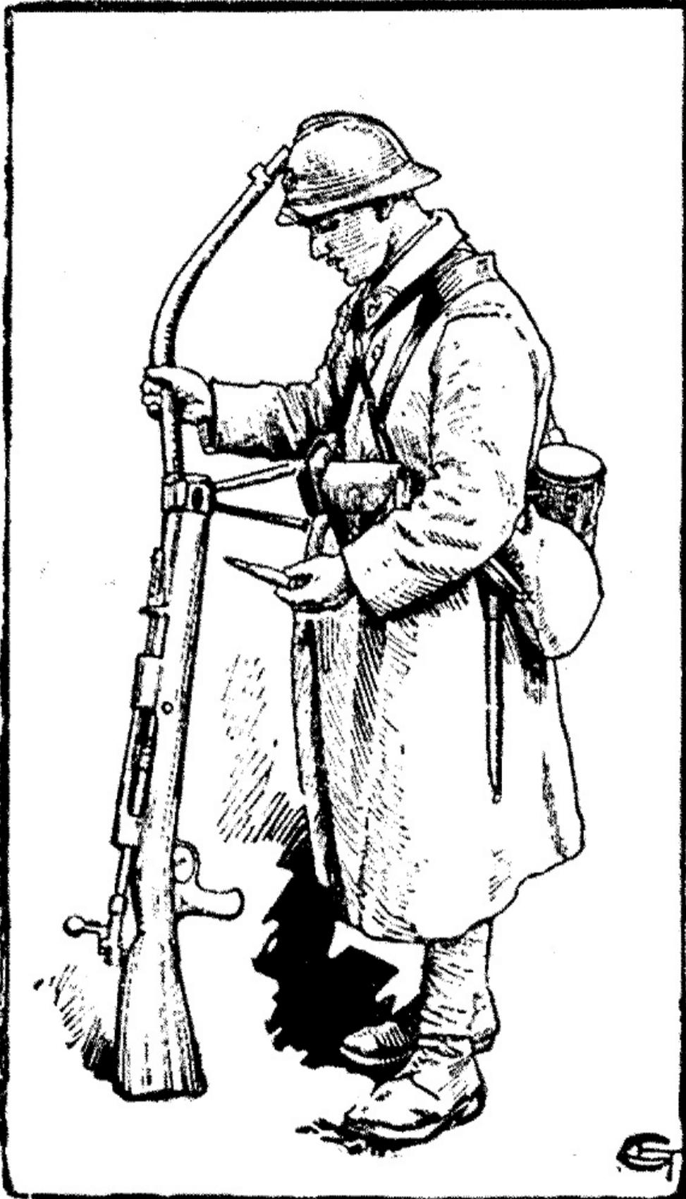
Les Allemands ont imaginé un gros fusil anti-tanks, dont voici un modèle capturé par nous. Le soldat tient dans sa main la balle du fusil ; celui-ci a eu son canon déformé précisément par un obus d'un de nos tanks. (Cl. Beaufrère.)
